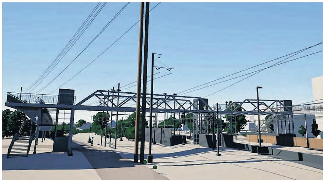
Heute wird die Passerelle ohne mittlere Rampe und aus Stahl geplant.
