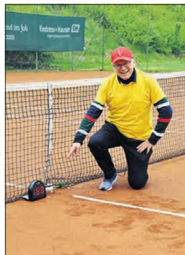
Beliebtes Gerät: Helfer Dieter Stohler zeigt die Box, welche die Aufschlaggeschwindigkeit misst.
