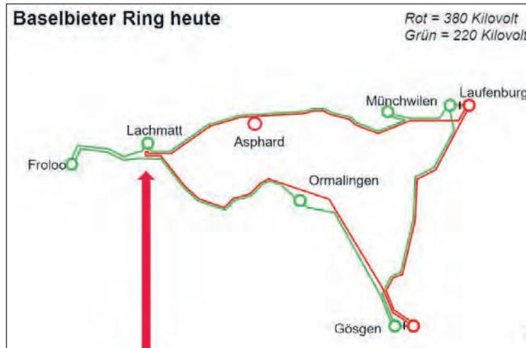
Das Unterwerk ist Bestandteil des sogenannten Baselbieter Rings (220-kV-Leitung Laufenburg – Münchwilen – Lachmatt – Frolool – Ormalingen – Gös gen). Dieser trägt massgeblich zur Versorgungssicherheit des Grossraumes Basel bei. Bereits heute ist dieser Ring stark belastet und bei Ausserbetriebnahmen fehlt eine Redundanz.
